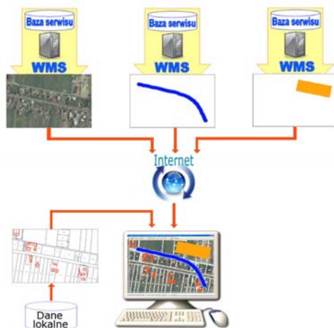
Rys. 9. Ilustracja działania klienta WMS
