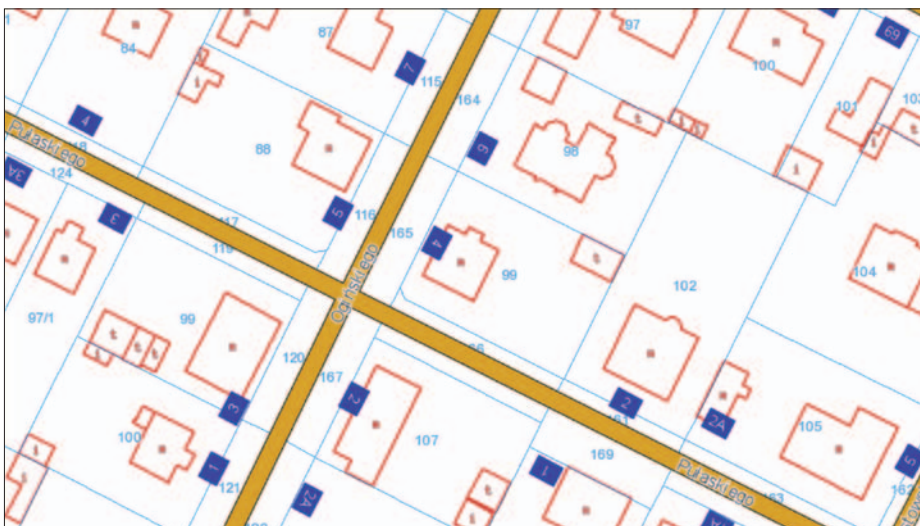
Rysunek 28. Wynik połączenia obrazów dotyczących tego samego miejsca z zapytań do dwóch serwerów WMS
